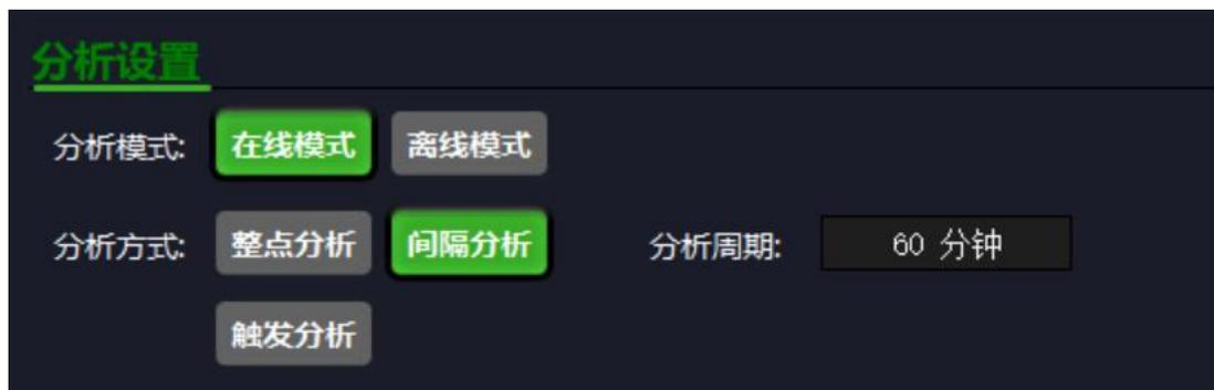
**整点分析：**是指仪器按照定时的整点时间进行分析，设置如图 6-4 所示，进行时间点设置。单击时间点可选中预分析时间，再次单击选中时间点则取消先选中，同时可通过右侧的“全选”、“全否”、“奇偶”进行快速选择，确定并单击仪器的“开始”按钮后，仪器按设定整点时间定时分析，例如图 6-4 所设置，仪器会在每天 01:00、03:00、05:00、07:00、09:00、11:00、13:00、15:00、17:00、19:00、21:00、23:00 进行分析操作。
